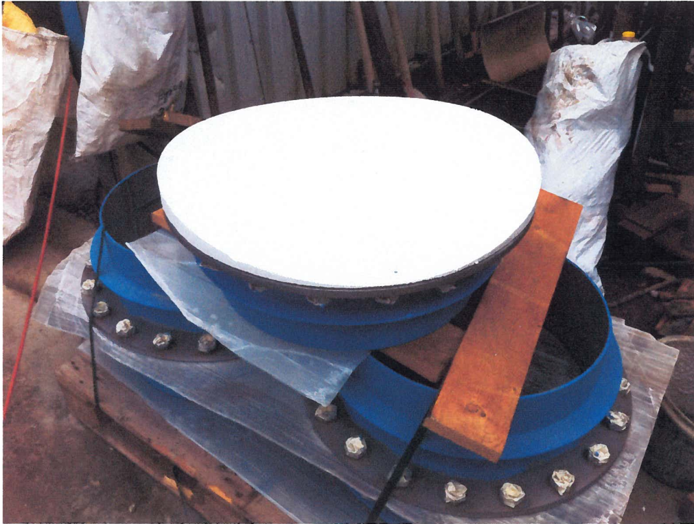
Kontrolle Schalmaß für die Schachtwanddurchführungen im Betonwerk
