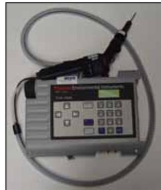
Nach entsprechender Inbetriebnahme (Kalibrierung, Aufwärmphase) des Gerätes kann mittels Handsonde an der entsprechenden Stelle gemessen werden.
