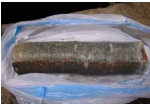
Kernbohrung aus der Schachtwand
