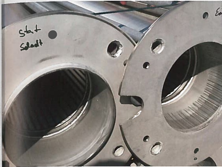
Abb. 8 – Links: Filter mit Spitzende, rechts: Filter mit Muffe
