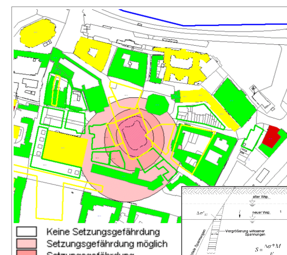
Bewertung der Setzungsgefährdung durch GIS-Verschnitt der prognostischen Grundwasser Oberfläche mit der historischen NNW-Grundwasseroberfläche
