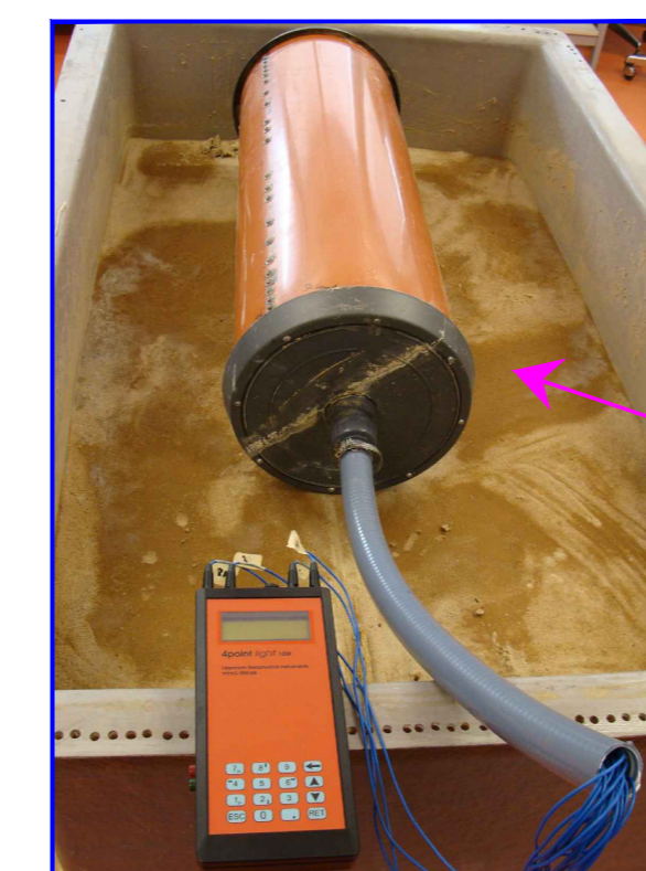
Rohr mit Messelektroden und externem Messgerät
